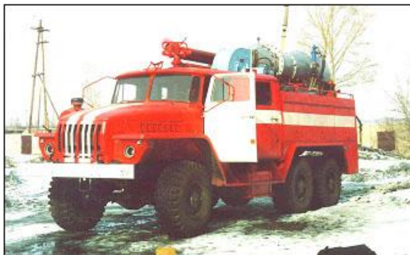
Рис. 5. Пожарный автомобиль с теплоэнергетической установкой на шасси Урал-375. Год разработки и выпуска – 1995-1996. Разработчик - Тюменская СНИЛ ВНИИПО. Заявлено: 6 л/с перегретой воды при давлении 10 атм. с температурой 150°C - 160°C.
