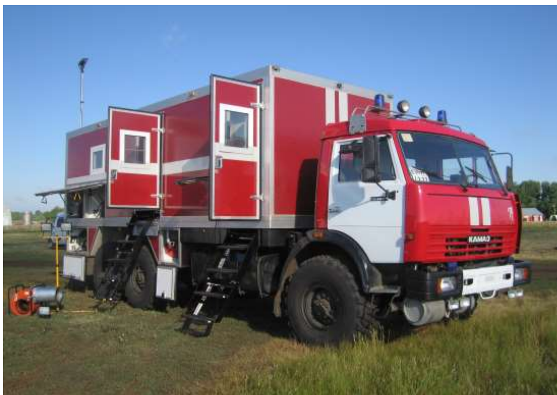
Рис.9. Автомобиль пожарный многоцелевой АПМ 3-2/40-1,38/100-100(43118) мод. ПиРо3-МПЗ
