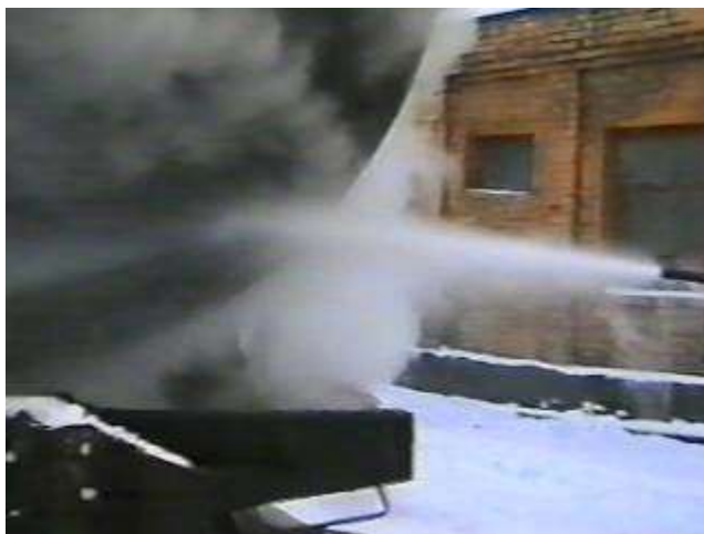
Рис.1. Очистка поверхности железнодорожной цистерны от отложений нефтепродуктов
