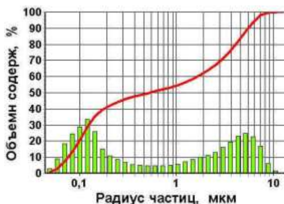
Рисунок 5 б – Распределение массовой доли капель по размерам. Сопло Лавалья с цилиндрической частью при T_B=200^\circ\text{C} .
