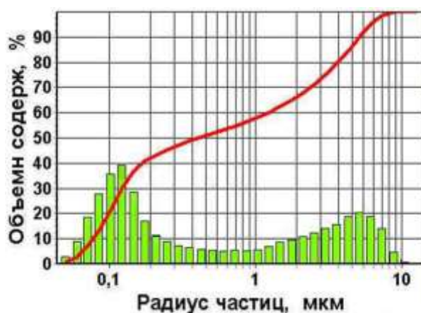
Рисунок 5 в – Распределение массовой доли капель по размерам. Шайба с острой кромкой при T_{в}=200^{\circ}\text{C} .
